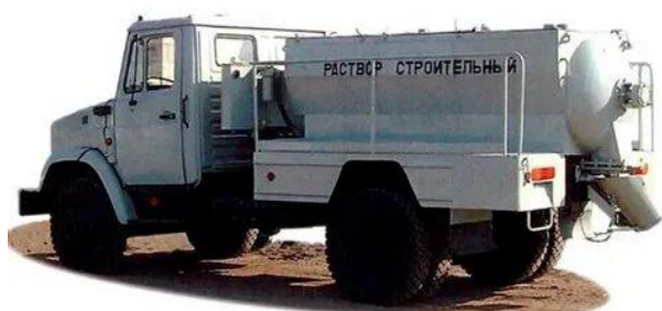
Рисунок 4. Авторастворовоз СБ89В (объем рабочей емкости 2,2\text{м}^3 ) на базе автомобиля ЗИЛ-431412
