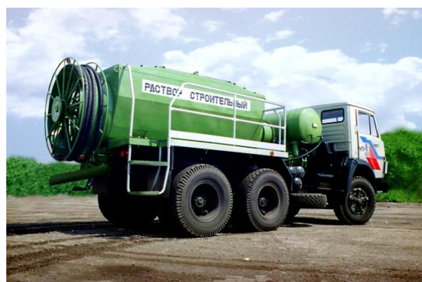
Рисунок 5. Авторастворосмеситель СБ-178 (объем рабочей емкости 2,6\text{м}^3 ) на базе автомобиля КАМАЗ 55111 (6x4)
